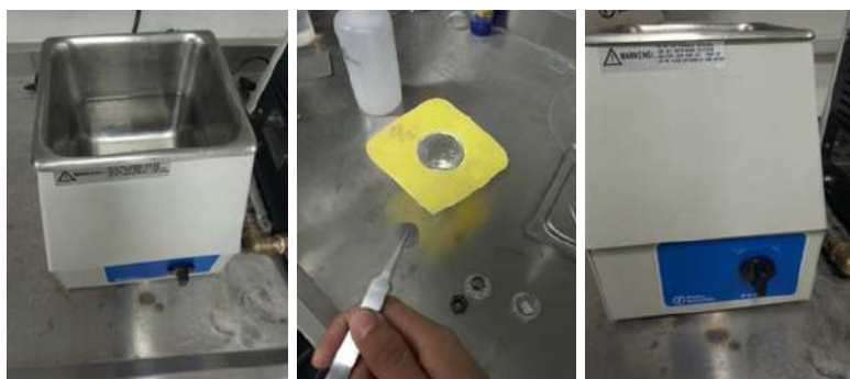
Figura 11.-Proceso de limpieza por medio de un baño ultrasónico de marca Fisher Scientific.
