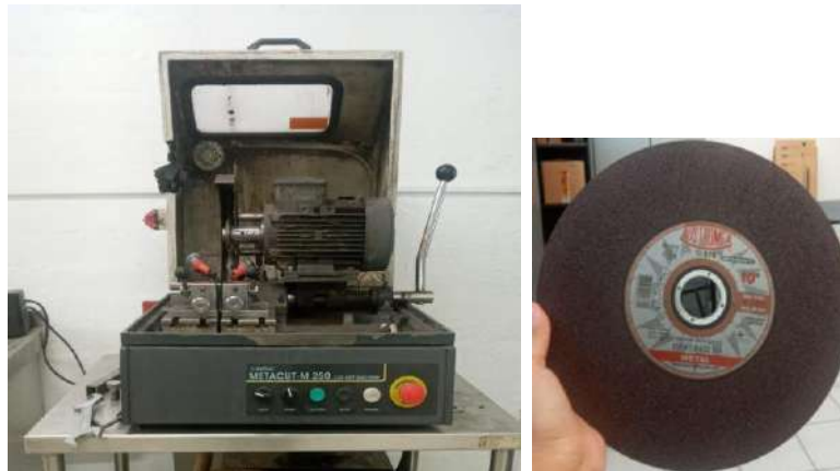
Figura 3. Máquina de corte y disco abrasivo empleado para el seccionamiento de las muestras.
