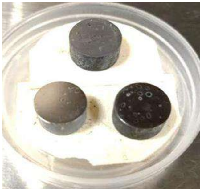
Imagen 12. Muestras sinterizadas a 850 °C, Matriz Ti-TiH 2 con refuerzo de 3, 10 y 30 % de TiB 2 .
