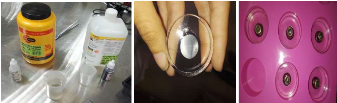
Figura 10.-Montaje de las muestras con resina.
