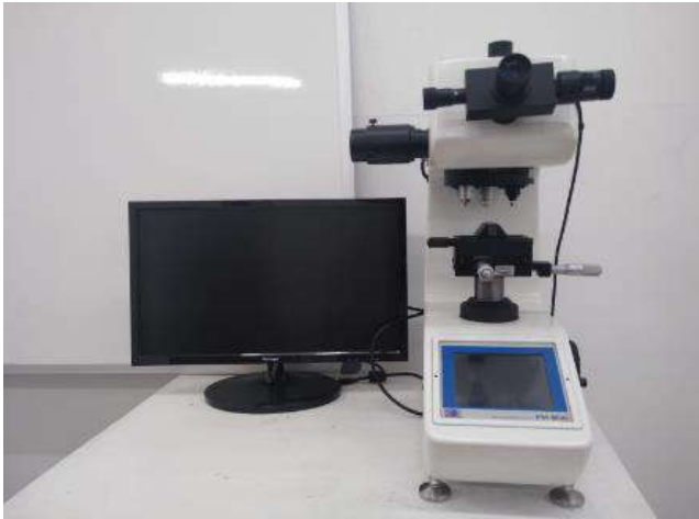
Figura 9: Micro indentador Vickers, marca Future-TECH.
