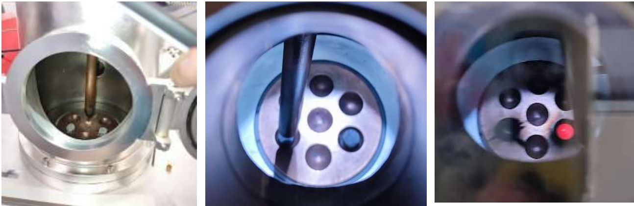
Figura 6. Proceso de fundición por horno de arco eléctrico
