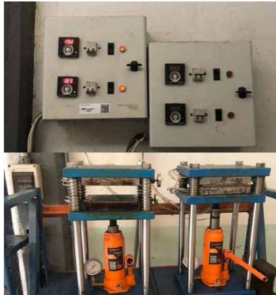
Figura 4. Prensa de termoformado con gato hidráulico TRUPER de 8 ton.
