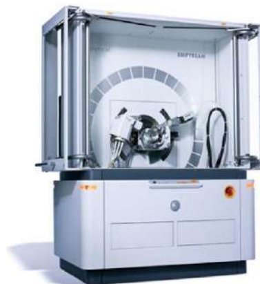
Figura 8. Equipo empleado para el análisis de XRD.
