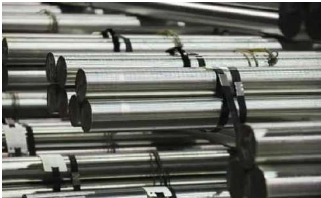
Figura 2: forma de venta comercial del acero D2. [8]
