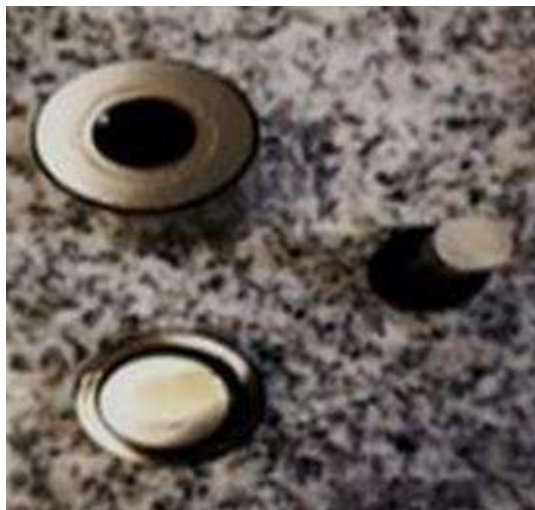
Imagen 4. Dado empleado para el proceso de compactación.
