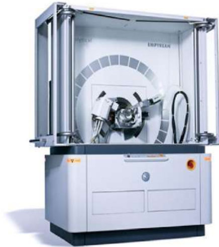
Figura 13.-Difractómetro, PANalytical modelo Empyrean.
