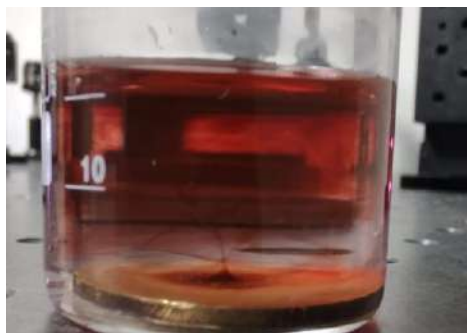
Figura 1. Síntesis de nanopartículas de Au por ablación láser de sólidos en líquidos
