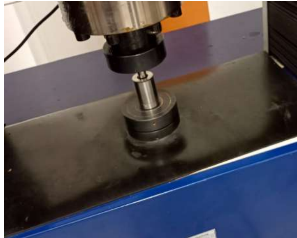
Figura 4.- Proceso de compactación en máquina de prueba universal de marca PTS (Physical Test Solutions).
