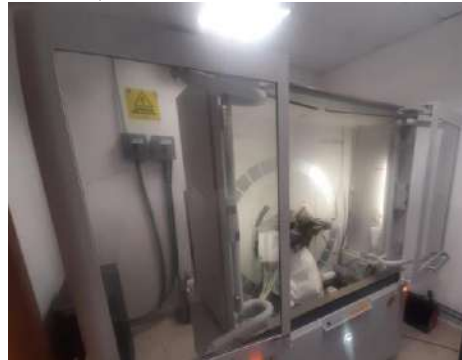
Figura 5. Difractómetro marca PANalytical modelo Epyrean
