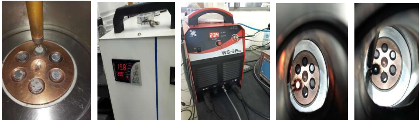
Figura 6.-Colocación de muestras en el crisol. Verificación de temperatura. Intensidad para generar el arco eléctrico. Muestra momentáneamente fundida. Muestra con enfriamiento respecto a la fundición.
