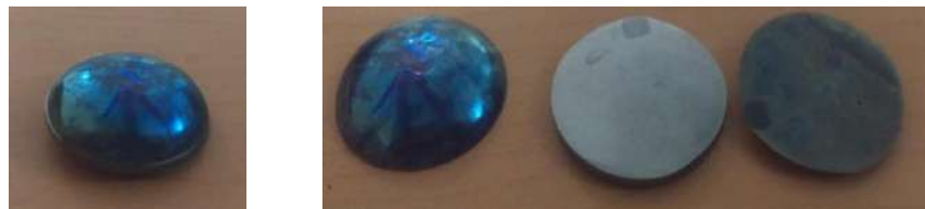
Figura 3. Ejemplo de las muestras obtenidas del procesamiento de fundición por arco eléctrico y seccionamiento de estas.
