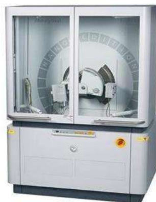
Ilustración 4 Equipo marca Empyrean, con una fuente de \text{CuK}\alpha .
