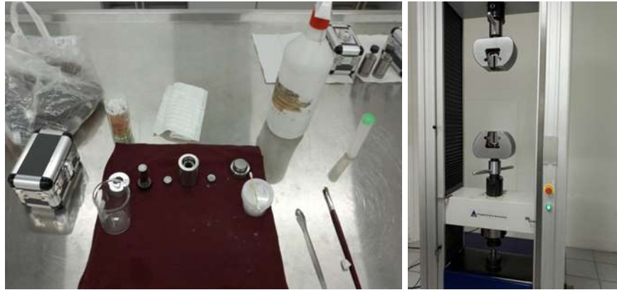
Figura 3.-Materiales utilizados en la compactación (extremo izquierdo) y la máquina de prueba universal de marca PTS (Physical Test Solutions) en el extremo derecho.
