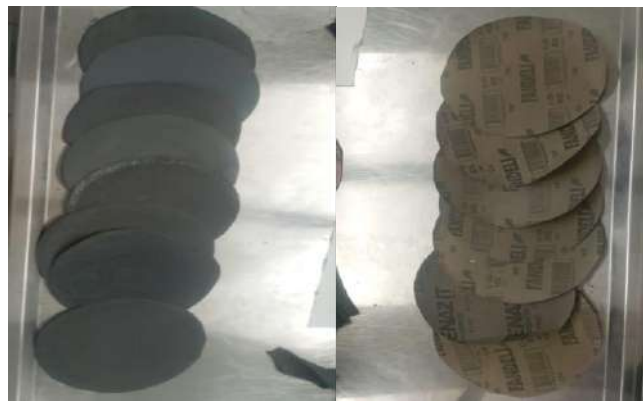
Figura 5. Hojas de lija de carburo de silicio con diferentes tamaños de partícula.
