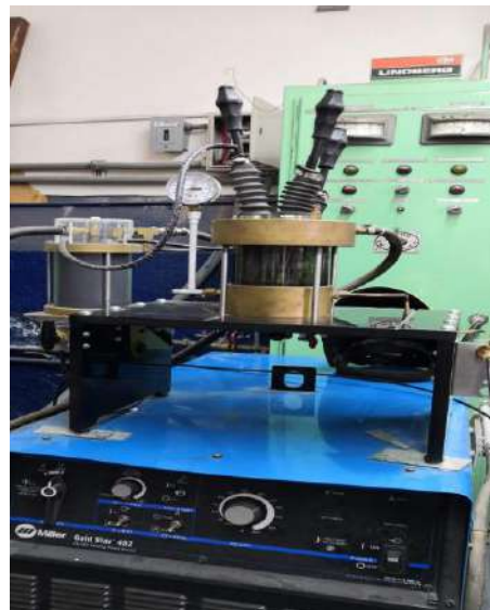
Figura 2. Horno de arco eléctrico utilizado para la fundición de las muestras.
