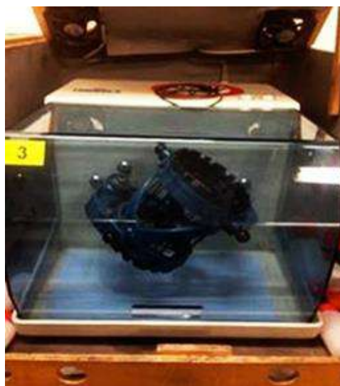
Imagen 3. Los polvos se introducen en la Túbula para lograr una mezcla homogénea entre los polvos de Ti CP, TiH 2 y TiB 2 .
