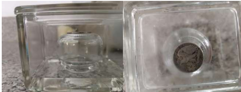
Figura 10. Aislamiento usado para la generación controlada de corrosión.
