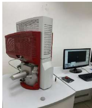
Figura 7.- Microscopio electrónico de barrido de emisión de campo (FE-SEM).
