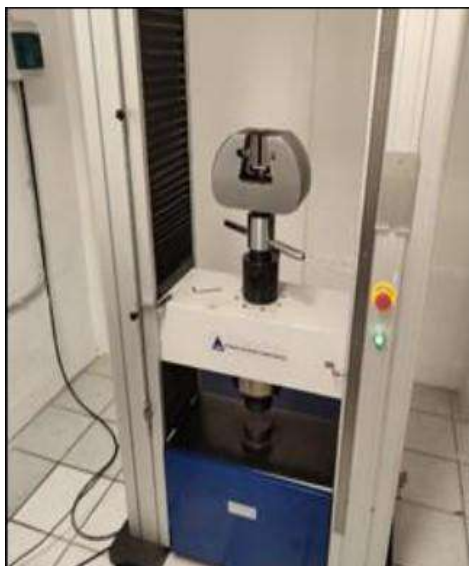
Figura 3. Equipo de pruebas universal servohidráulica MTS810.
