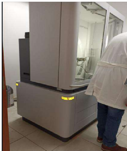
Figura 8. Difractómetro de rayos X (Empyrean PANalytical).
