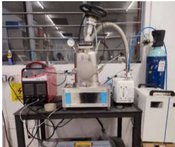
Figura 5. Horno de arco eléctrico
