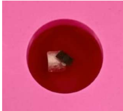
Figura 8.- Formado de endurecimiento de resina.
