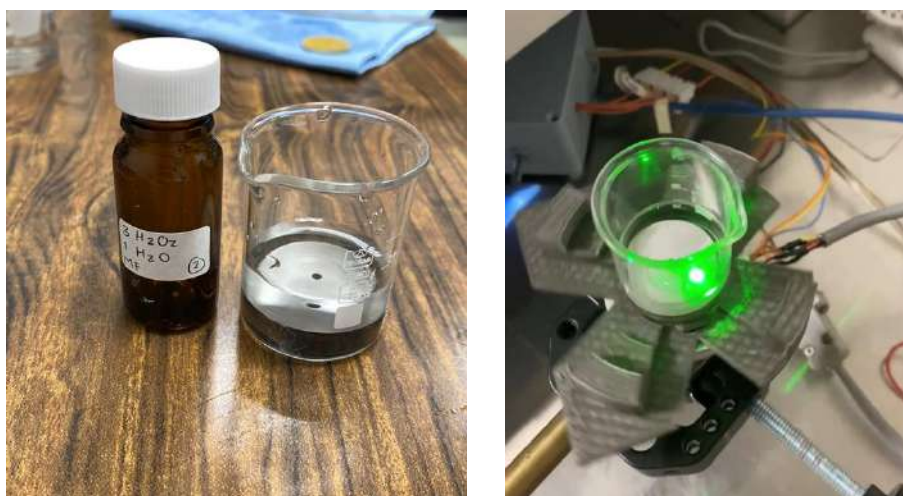
Figura 2: Moneda de titanio de 99.99% de pureza en solución (izquierda) y arreglo rotatorio del portamuestras donde incide el láser (derecha)
