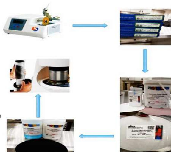
Imagen 7. Esquema del proceso metalográfico convencional.
