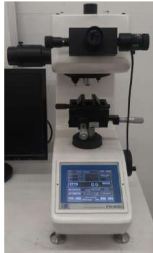
Figura 7. Microdurómetro Future-Tech FM-800
