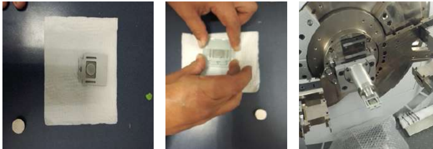
Figura 14.-Colocación de la muestra en el difractómetro, PANalytical modelo Empyrean.
