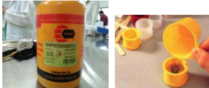
Figura 4. Resina y proceso de vaciado en los moldes.
