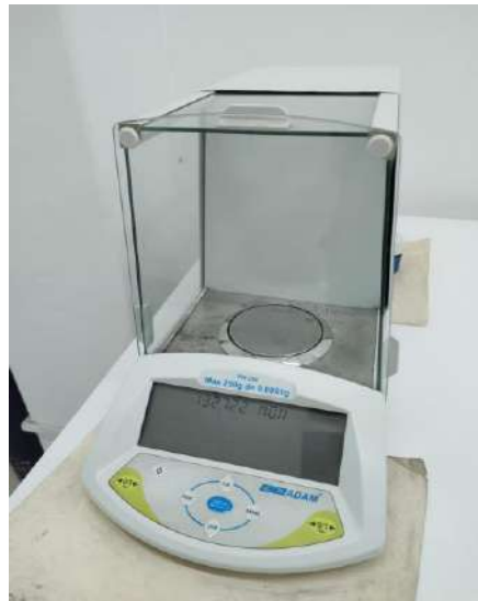
Figura 2. Balanza digital de la marca ADAM PW 254. Max 250 g d= 0.0001g.
