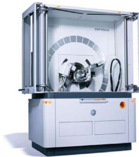
Figura 6. Equipo empleado para el análisis de XRD.
