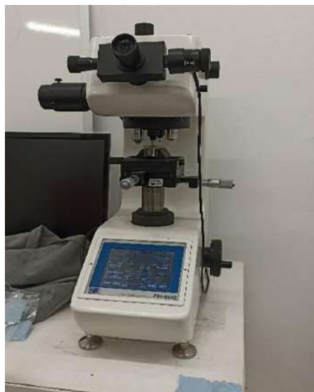
Figura 11. Indentador Vickers Future-Tech, modelo FM800.
