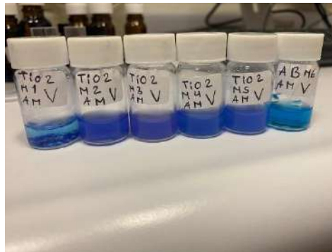
Figura13: muestras de azul de metileno con solución de NPs de TiO 2 irradiadas durante 2 horas.
