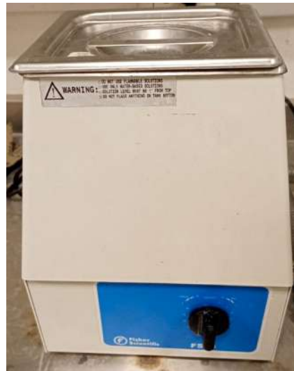
Figura 10.- Equipo ultrasónico de la marca fisher scientific.
