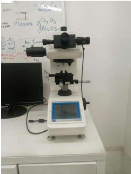
Figura 11. Microdurómetro Vickers Future-Tech FM-800 y esquema representativo de las mediciones de las huellas de indentación.
