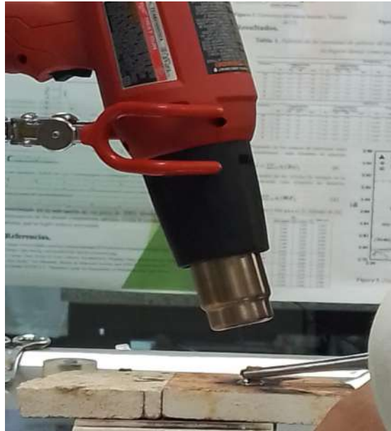
Figura 9.- Proceso de soldado del tubo de latón y de la muestra con estaño por medio de una pistola de calor Milwaukee 2.
