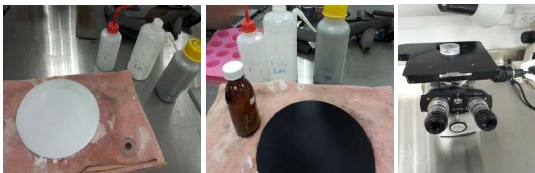
Figura 11.-Materiales utilizados en el proceso de pulido con: 3\ \mu\text{m} alúmina, 1\ \mu\text{m} alúmina, 0.05\ \mu\text{m} alúmina y con sílica coloidal y microscopio óptico de la marca UNION.
