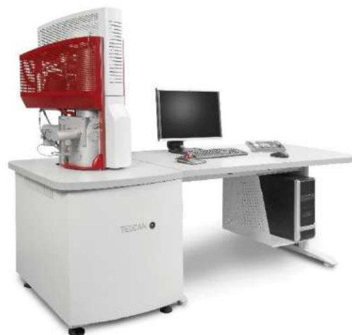
Imagen 11. Microscopio electrónico de barrido de campo, marca TESCAN, modelo MIRA 3 LMU.
