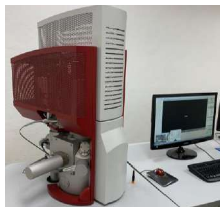
Figura 7. Microscopio electrónico de barrido de emisión de campo (FE-SEM).
