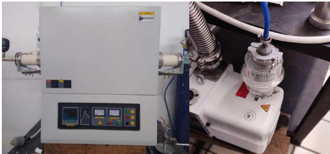
Figura 4. Horno de sinterizado conectado a una bomba de vacío (Thermoelectric Inc. Modelo TH1200).
