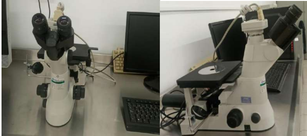
Figura 8. Microscopio óptico Nikon Eclipse MA100.
