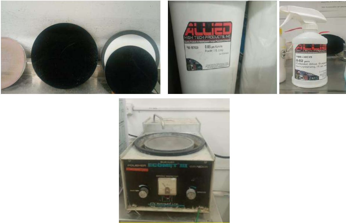
Figura 6. Máquina pulidora empleada para el proceso de pulido y materiales consumibles empleados durante el proceso (paños, polvo de alúmina y solución de sílica coloidal).
