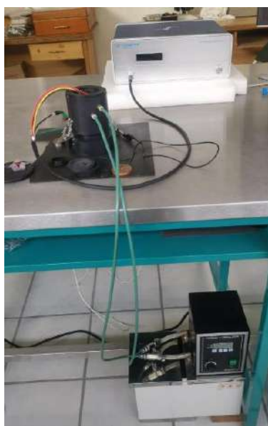
Imagen 14. Arreglo experimental prueba LPR y EIS.
