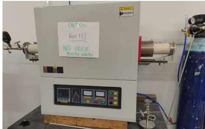
Figura 3.- Horno de tubo programable utilizado para el proceso de sinterizado.
