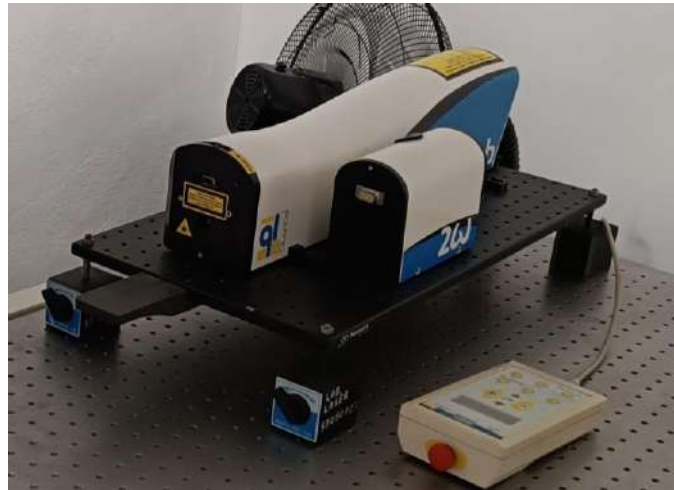
Figura 12. Láser Nd: YAG, Quantel Brilliant b.
