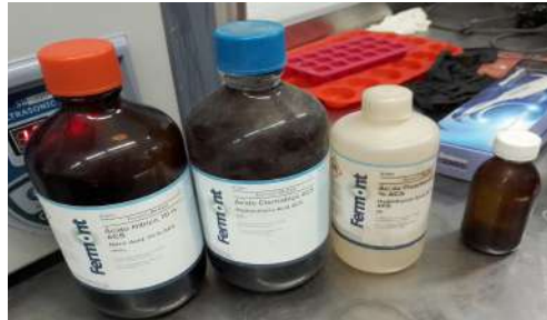
Figura 15.-Soluciones indispensables para la preparación de la solución Kroll.
