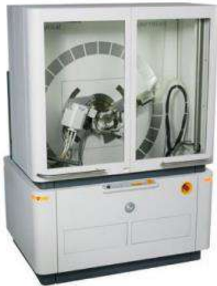
Figura 7: Diffractómetro marca Panalytical, modelo: Empiryam
