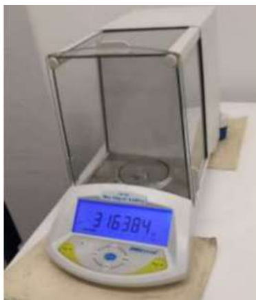
Figura 2. Balanza analítica digital ADAM PW
