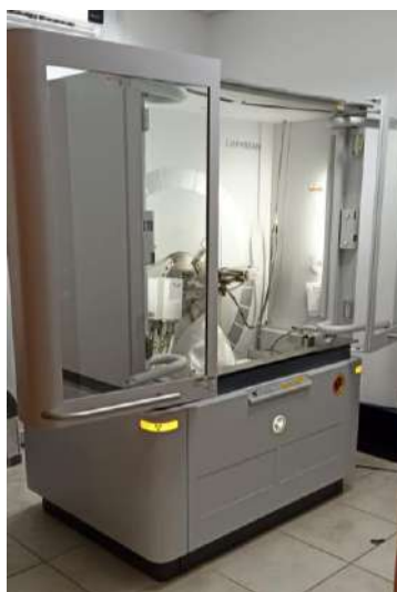
Figura 2. Difractómetro PANalytical Empyrean.
