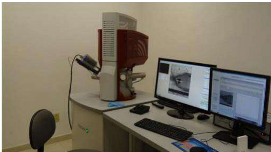
Ilustración 3 Microscopio electrónico de barrido de emisión de campo (FE-SEM) Marca Tescan modelo MIRA 3 LMU, de alta resolución. Cuenta con micro sonda para microanálisis superficial por medio de espectroscopia de energía dispersiva de rayos x (EDS) marca Bruker con rango de detección del Boro al Americio y resolución de 129 nm.
