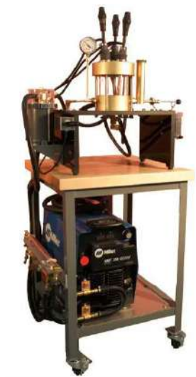
Figura 2.- Horno de arco eléctrico Arc Melt Furnace TA-200. Modificada de (Arc Melt Furnace TA-200 - Materials Research Furnaces, LLC).
