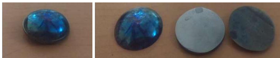
Figura 3.- Ejemplo de las muestras obtenidas del procesamiento de fundición por arco eléctrico y seccionamiento de estas.
