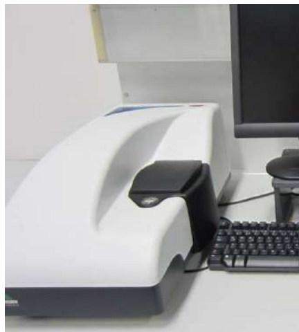
Figura 2. Equipo Zetasizer Malvern Panalytical Nano ZS.
