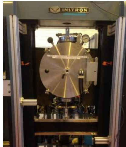
Imágenes 7 a) Colocación de muestras en el crisol. La cúpula del crisol tiene una entrada para el termopar y b) BrewFurnace, horno de alto vacío ( 1 \times 10^{-6} mbar).
