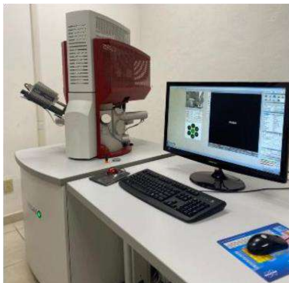
Figura 9. Microscopio electrónico de barrido (TESCAN Mira 3 LMU).
