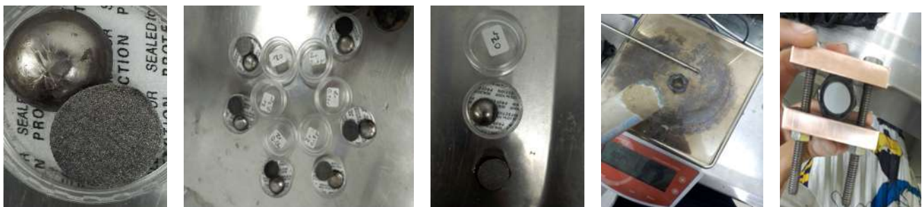
Figura 7.-Muestras seccionadas por electroerosión por hilo y adheridas a una tuerca con un dispositivo por medio de parrilla de la marca BANTE.
