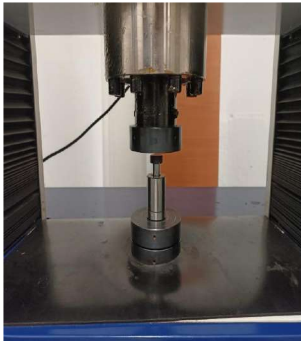
Figura 3. Máquina de ensayos universales Physical Test Solutions modelo FMCC-200.
