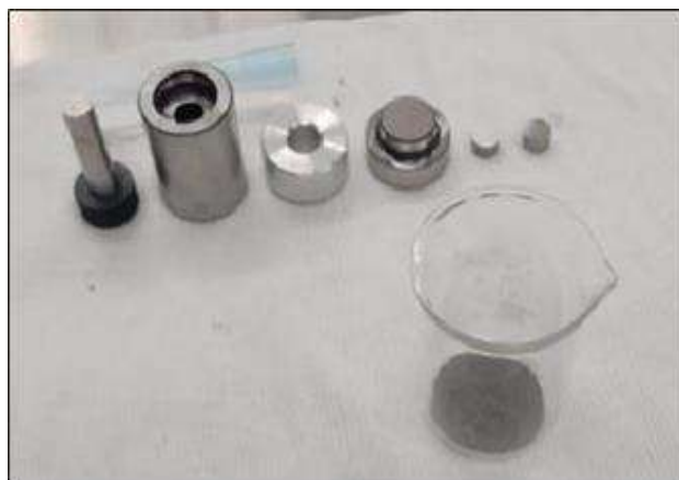
Figura 2. Elementos necesarios para la mezcla y compactación de los polvos de Ti64 y el CeO 2 .
