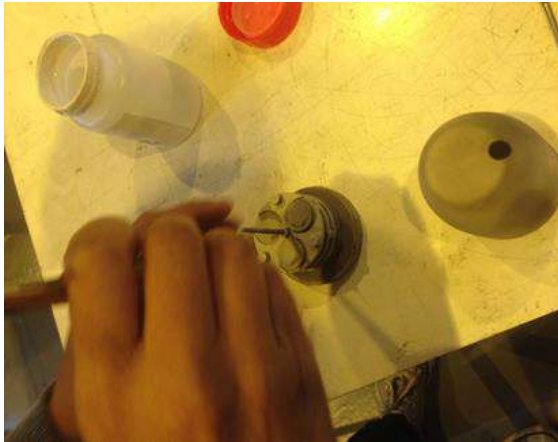
Imágenes 7 a) Colocación de muestras en el crisol. La cúpula del crisol tiene una entrada para el termopar y b) BrewFurnace, horno de alto vacío ( 1 \times 10^{-6} mbar).
