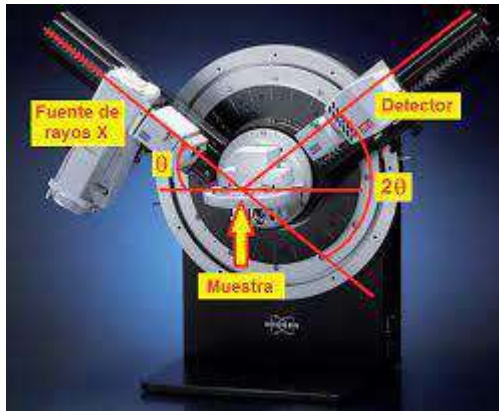
Figura 4: Funcionamiento de un equipo de XRD. [14]
