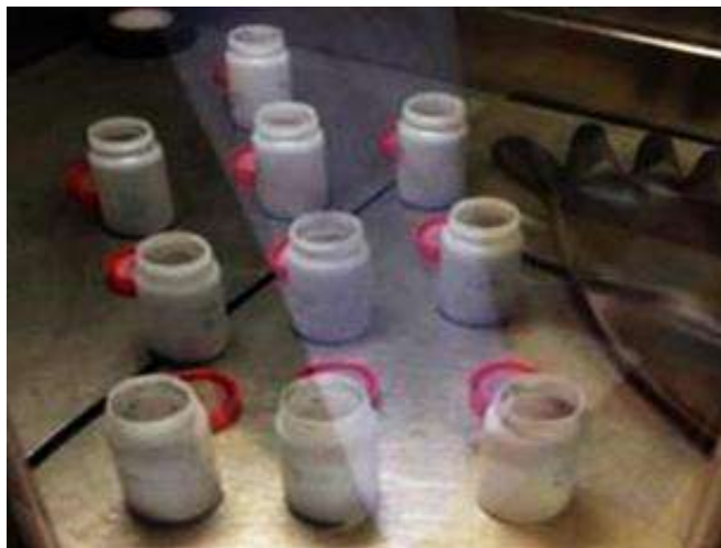
Imagen 2. Recipientes de polietileno con la mezcla de los polvos de Ti CP, TiH 2 y TiB 2 como refuerzo, dentro de la cámara de guantes.
