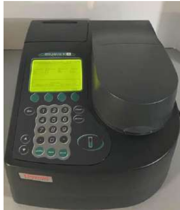
Figura 1. Espectrómetro UV-Vis Thermo Fisher Scientific modelo Genesys TM 10 Bio.
