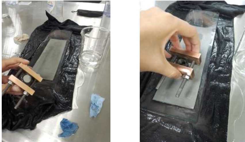
Figura 8.-Desbaste de la muestra con la ayuda de dispositivo.
