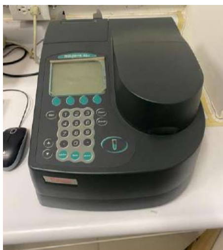
Figura 2.- Equipo UV-Vis ThermoFisher Scientific modelo Genesys™ 10 Bio.
