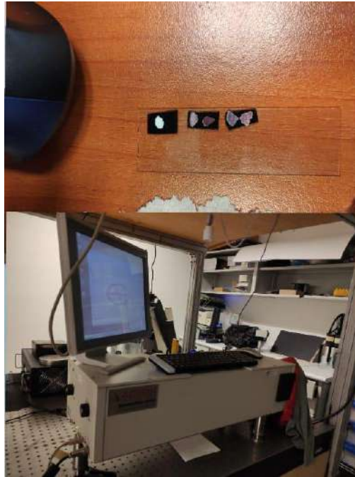
Figura 3. Preparación de las muestras para espectroscopía Raman y equipo empleado.
