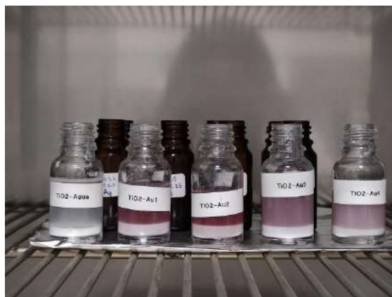
Figura 2. Muestras de \text{TiO}_2 con nanopartículas de Au colocadas en el horno para lograr evaporar el líquido presente en ellas.
