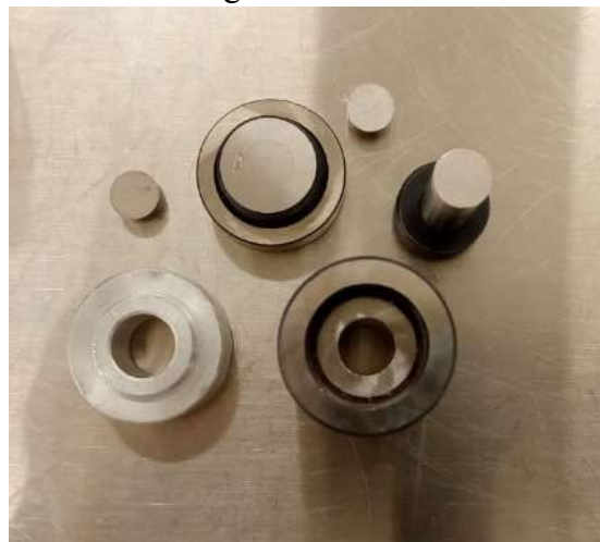
Figura 3.- Herramental utilizado para proceso de compactación.
