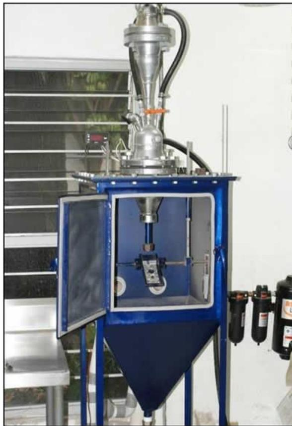
**Descripción y datos técnicos:** Con entrada de aire seco y capacidad de controlar variables como, velocidad de impacto, ángulo de impacto, medio erosivo y distancia de impacto.
