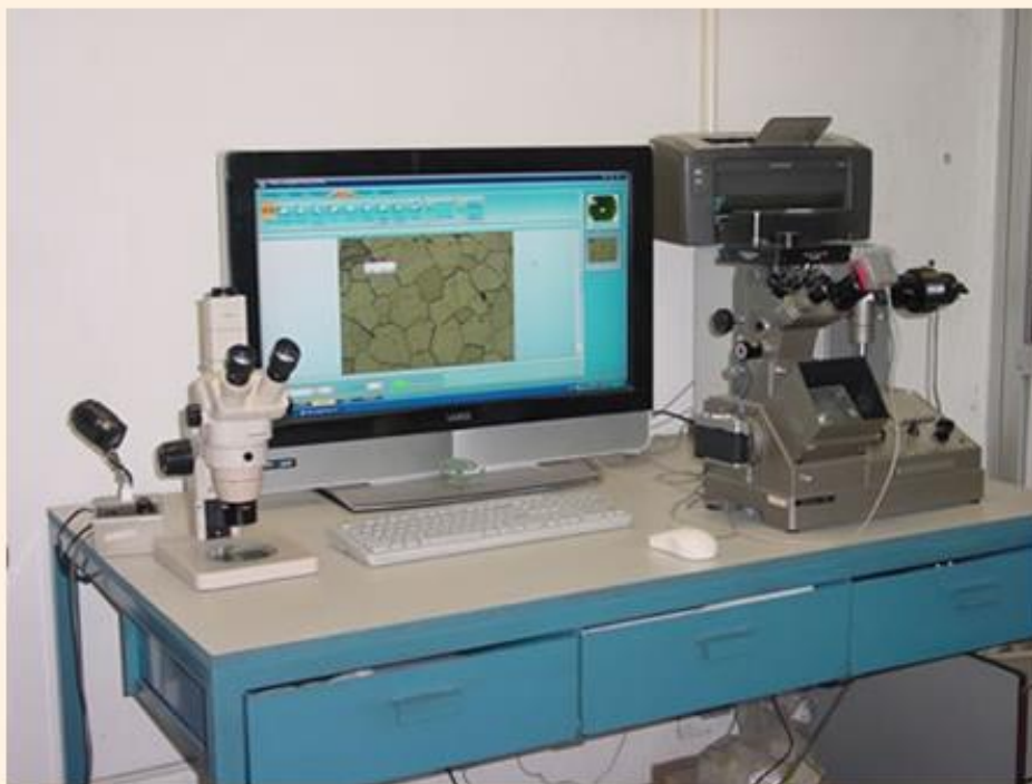
Microscopio metalográfico, estereoscopio y análisis de imagen.
