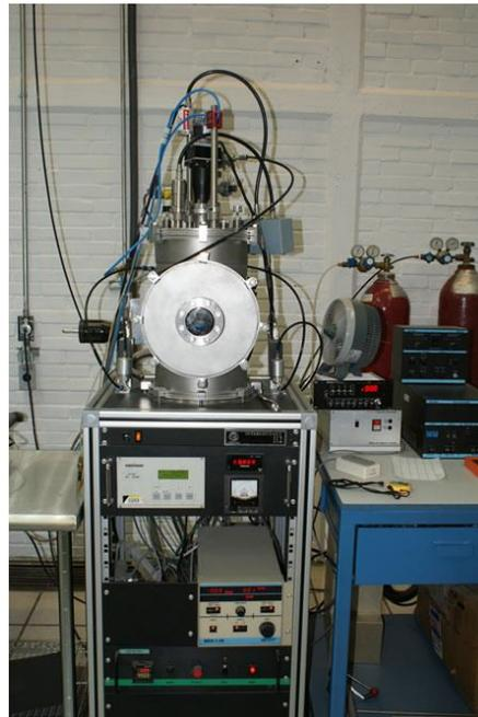
**Descripción y datos técnicos:** Cuenta con cámara de depósito al vacío con cuatro magnetrones para depositar multicapas por medio de la técnica de erosión iónica (sputtering), fuentes DC y RF y HIPIMS, calentador de sustratos con cuatro estaciones con capacidad de movimiento, control de hasta dos gases.
