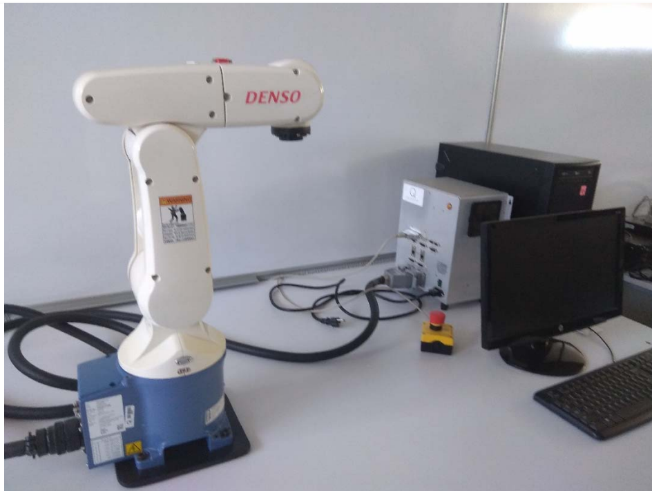
Fig. 20. Robot manipulador Denso-V6, con 6 grados de libertad
