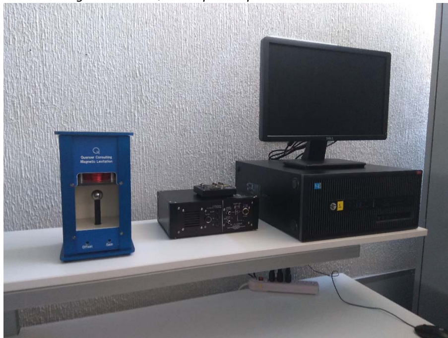
Fig. 17. Maglev, equipo para experimentar con el control de un levitador magnético
