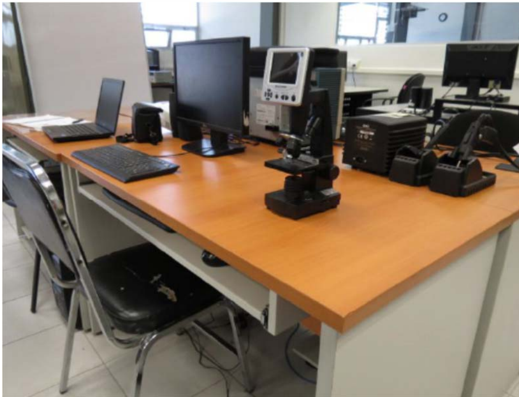
Fig. 45 Una estación con Microscopio digital con cámara CCD incluida, salida a monitor.
