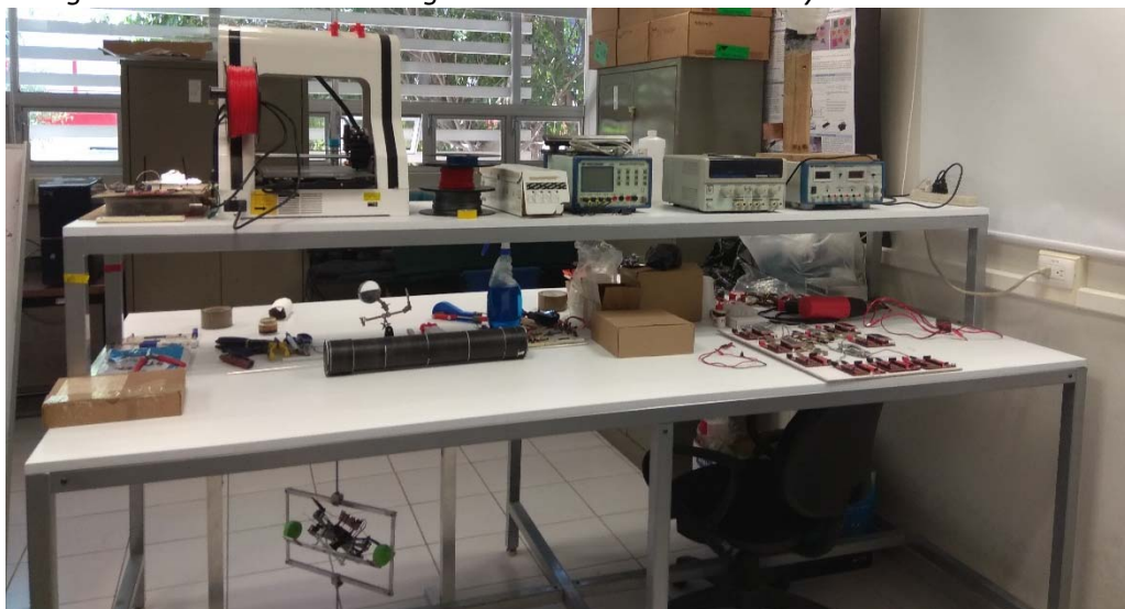
Fig. 39 Estaciones de trabajo para prototipado rápido con tarjetas de evaluación FPGAs, osciloscopios, analizador lógico portable y fuentes programable.
