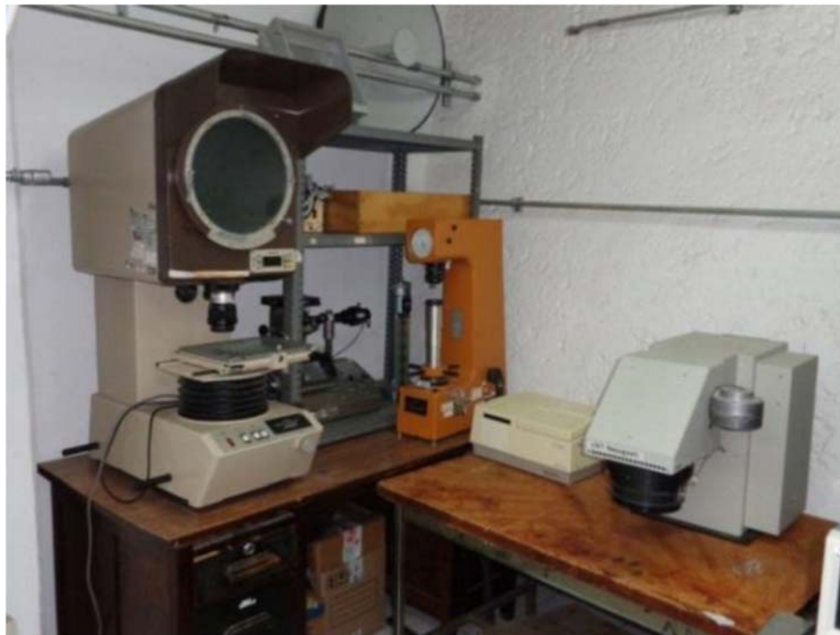
Fig. 31 Equipo de metrología dimensional, en la imagen se muestra una mesa de coordenadas.
