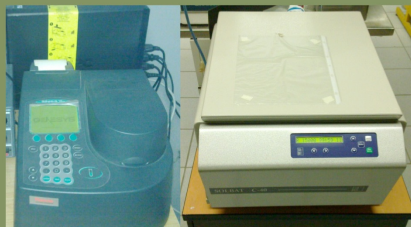
Sistema UV-Visible para mediciones de transmisión en el rango de 200 – 1100 nm. y centrífuga de alta velocidad
