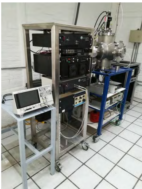
Fig. 1, Sistema de fuentes DC, pulsadores HIPIMS y sincronizador.
