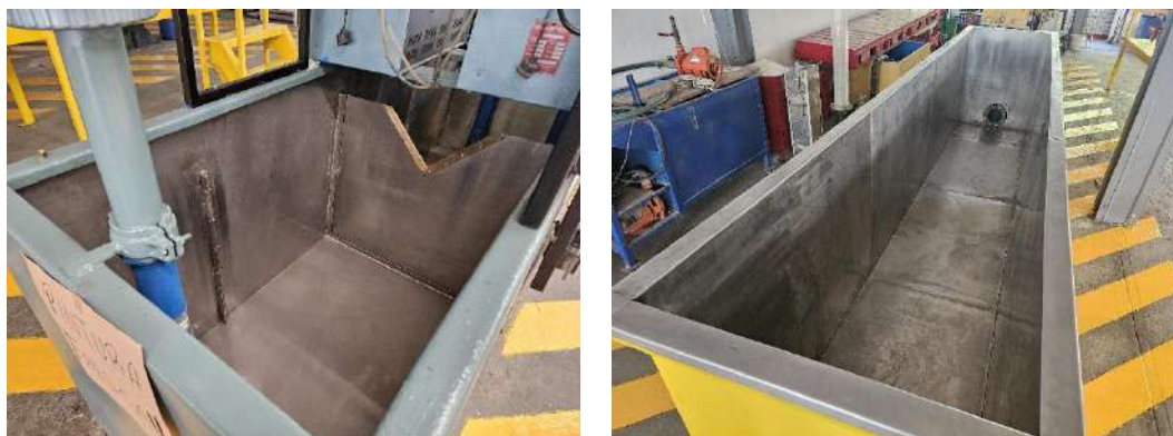
Imagen 5. Tanques fabricados en lámina de acero inoxidable calibre 14".
